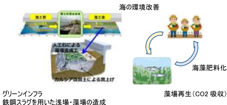
図 8-9 漁港のグリーンインフラ整備や藻場再生と CO 2 削減対策のイメージ
